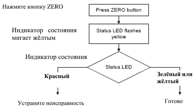
Рисунок 3-4 Процедура установки нуля расходомера с помощью кнопки Zero (Ноль)
